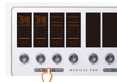
④SELECTボタンを約2秒長押しで、 編集開始する。
