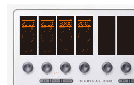
⑧SELECTボタン約2秒長押しで、 登録完了する。
